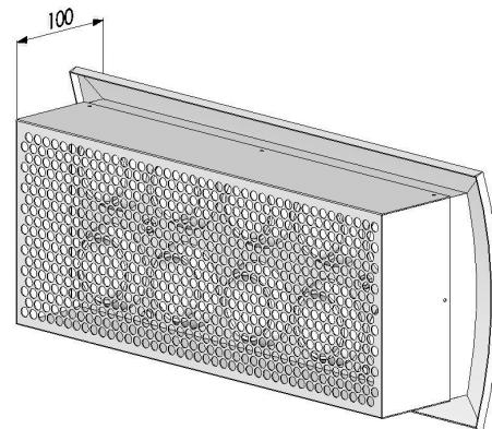
BUGRC avec grille d'équilibrage réalisée en acier galvanisé perforé
